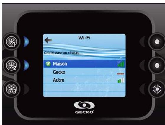
Lorsque le module in.touch est connecté à un réseau WiFi, un crochet vert apparaît dans le menu Wi-Fi et le nom du réseau est affiché dans le menu *Réglages*.
